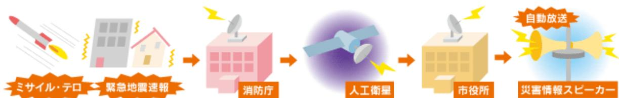
弾道ミサイル・テロ情報、緊急地震速報など → 消防庁 → 人工衛星 → 市役所 → 災害情報スピーカー（自動放送）
