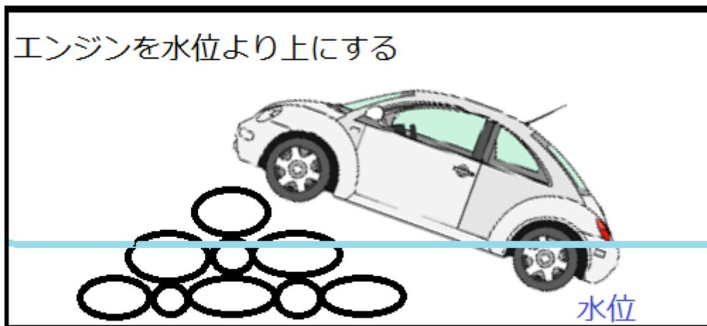
時間のある場合は土のうをしっかり設置しますが、緊急の場合は前輪側だけでも土のうを設置しましょう。一般の車両はエンジンが前にあるので、前輪側を高くすることで守ることができます。
