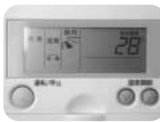
電気使用量削減に有効な空調温度の適正化
